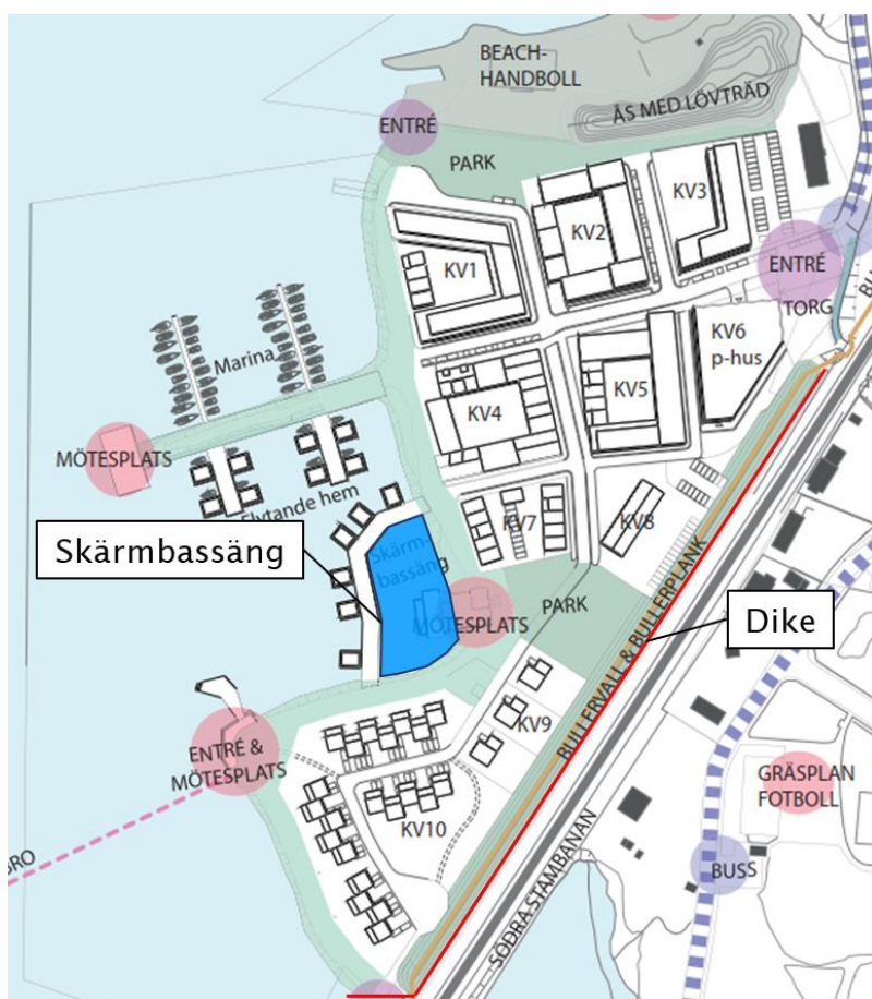
Figur 9: Översikt över föreslagen dagvattenhantering. Skärmbassängens placering är utmärkt med blått (modifierad från principskiss erhållen av Älmhults kommun)
